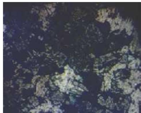
Struktur micro baja karbon rendah dengan proses carburizing waktu tahan 3 jam.
